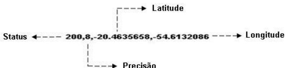
**Figura 1.2** – Detalhamento de um retorno CSV
